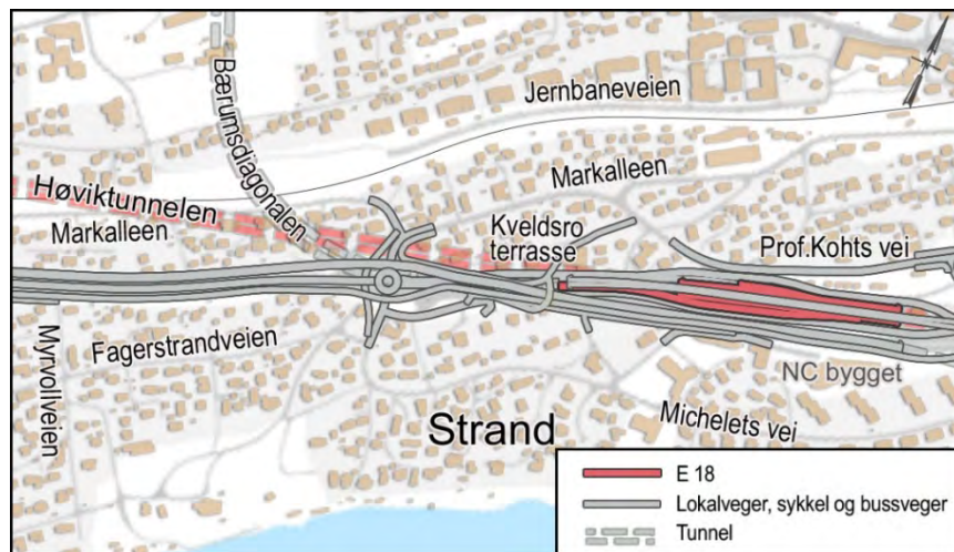
Figur 2: Systemtegning som viser løsninger for E18 i forslag til reguleringsplan Lysaker-Ramstadsletta
