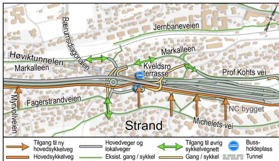
Figur 6: Systemtegning som viser løsninger for gang- og sykkel i forslag til reguleringsplan Lysaker-Ramstadsletta
