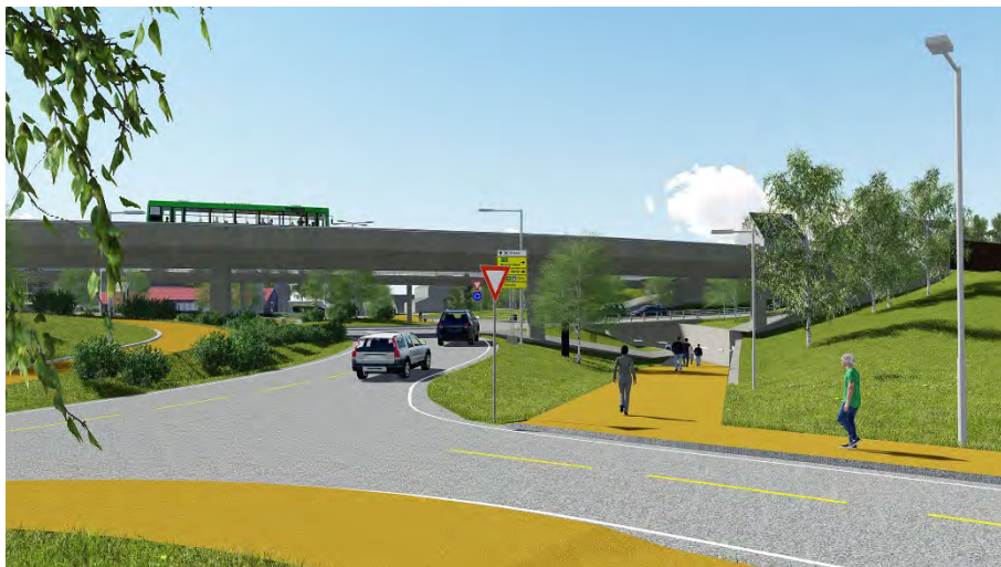
Figur 28: Reguleringsforslagets løsning. Strandkrysset sett sørover fra Markalléen. Det blir undergang under lokalvegen for gang- og sykkeltrafikk. Hovedsykkelveg og bussveg går i bru over krysset.
